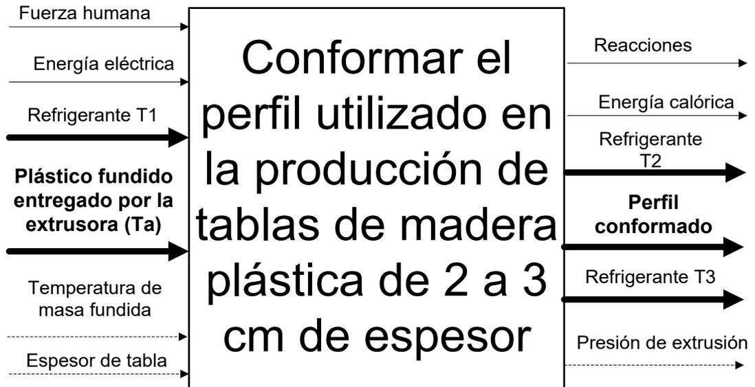
**Ilustración 37.** Estructura funcional del sistema para el conformado continuo del perfil utilizado en la elaboración de tablas de madera plástica en la empresa Plasmaco
