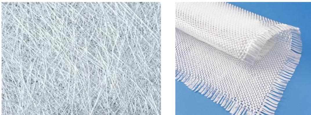
Figura 10 y 11. De izquierda a derecha tenemos tejido tipo MAT y woven roving de fibra de vidrio. (Fuente:en.fukesi.com y <http://gssfiberglass.com>)
