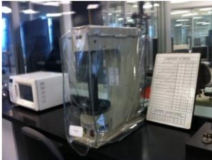
Figura 17. Durómetro HÄRTEPRÜFER GNEHN (tomado de: Laboratorio de materiales Universidad EAFIT, Medellín, Colombia)
