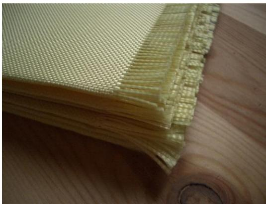
Figura 9. Manta de TWARON bidireccional (Fuente: <http://www.splav.ru/press/info/bron/bron.aspx>)
