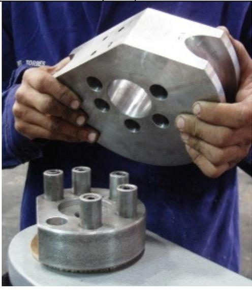
**FOTO 12.** Posicionamiento del eje del dado
