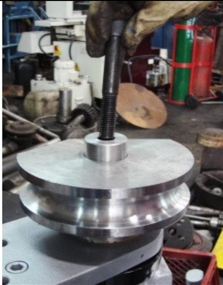
**FOTO 14.** Ensamble del sujetador del tubo en C con el dado
