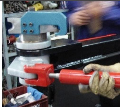
**FOTO 18.** Ubicación de los cilindros hidráulicos en las horquillas e instalación de las mangueras hidráulicas
