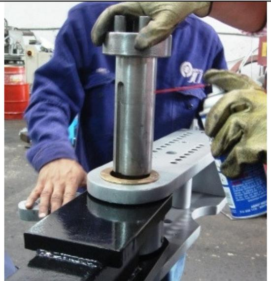
**FOTO 11.** Ensamble dado con el eje principal
