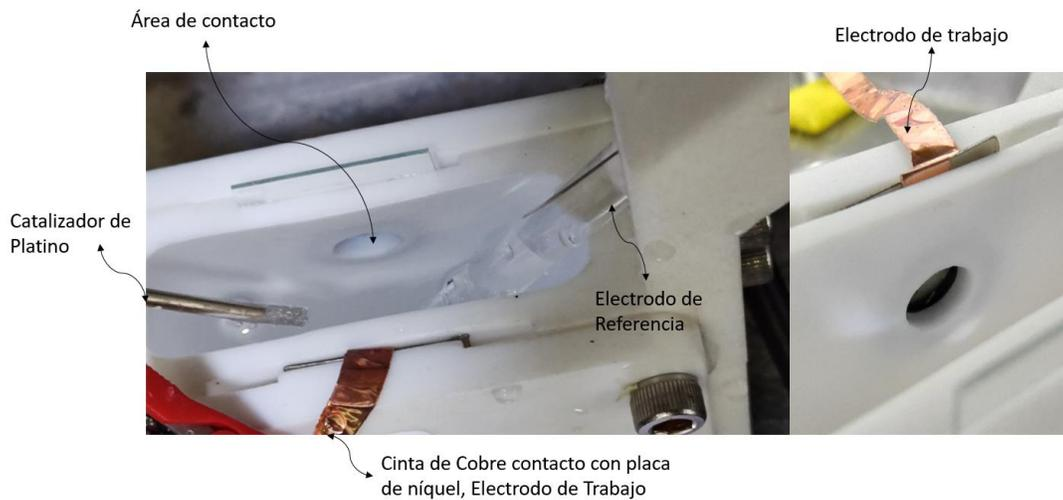
**Figura 5** Posiciones de conexiones de electrodos de trabajo, catalizador y referencia
