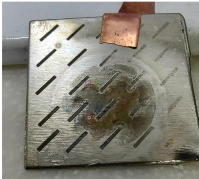
**Figura 18** Placa Níquel Patrón Angular 45°.
