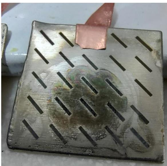
**Figura 20** Placa Níquel Patrón Angular 135°.
