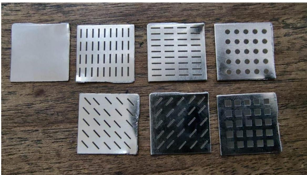
**Figura 3** *Diferentes tipos geometrías patrón grabado con láser en placas galvanizadas de níquel*
