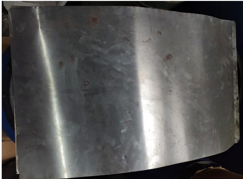
**Figura 2** *Lamina de Acero F1120; 1.20x50cm espesor 0.40mm*
