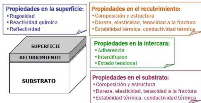
Figura 3.1 Esquema general del binomio recubrimiento–substrato (10).
