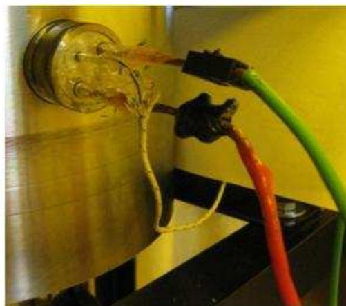
**Figura 5.5** Pasamuros para el horno de calentamiento de la muestra (Elaboración propia).
