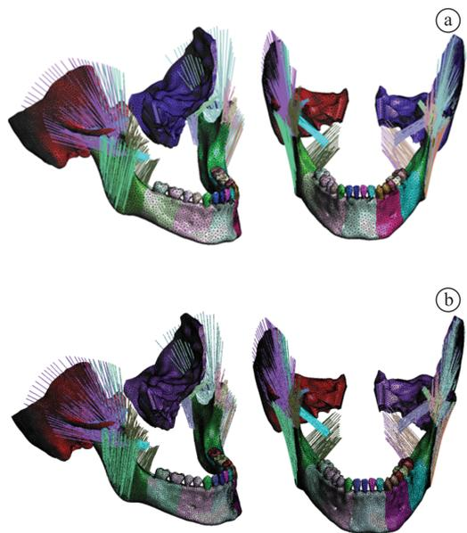
Figura 8. a) Malla de 239.170 elementos y 356.237 nodos; b) Malla de 441.235 elementos y 653.027 nodos.
