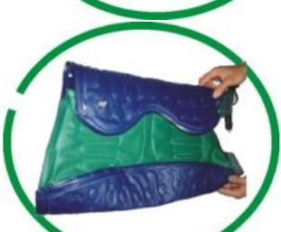
Disposición de textura en la estructura, reduciendo áreas horizontales de aire para garantizar pliegues dando la estabilidad estructural de los canales.
