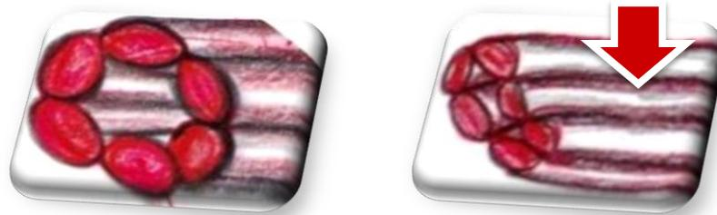
El sellado unilateral horizontal se modifica por formas bilaterales, donde las partes que forman los laterales, por estar en forma vertical, cargan con el esfuerzo generado en la parte superior, forzando el control formal del ducto cuadrado que garantiza el paso del aire.
