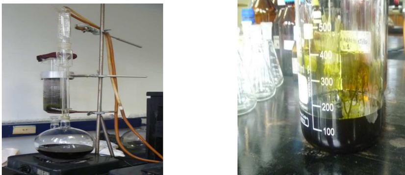
**Figura 13.** (a) Extracción Soxhlet (b) Material Obtenido de la Extracción.
