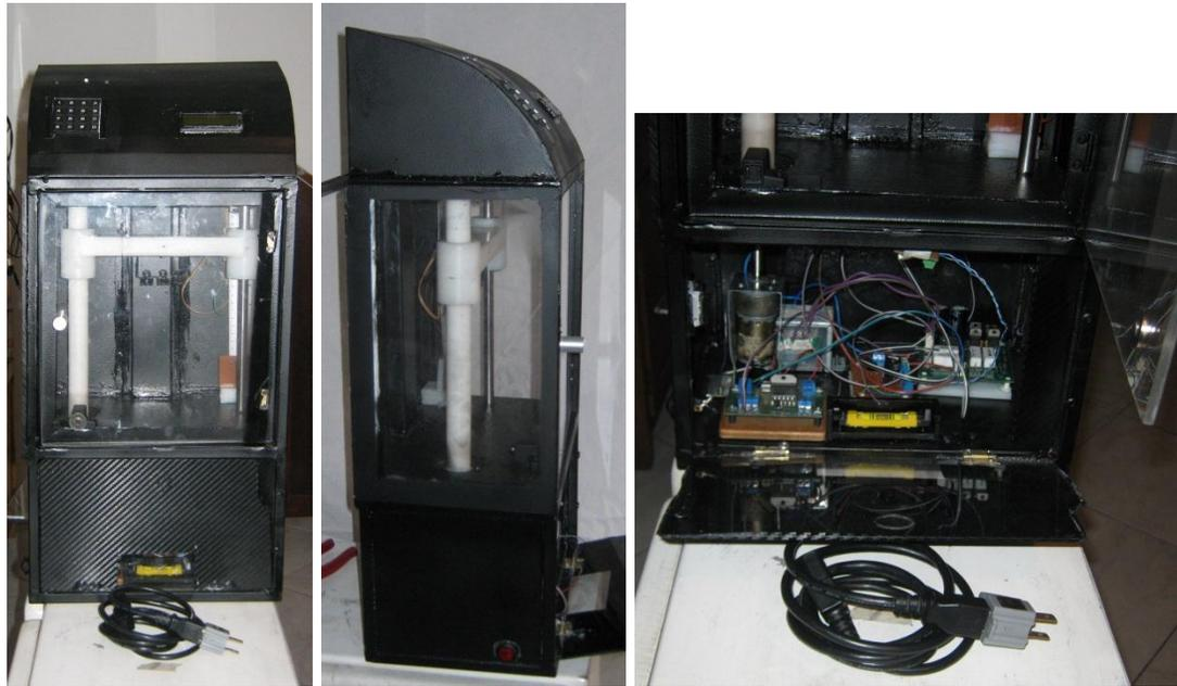
**Figura 41. Aspecto del Dip Coater 136. Arriba izquierda: Vista frontal, Arriba derecha: Vista lateral izquierda, Abajo: Vista frontal con tapa inferior abierta con el cable de alimentación necesario.**
