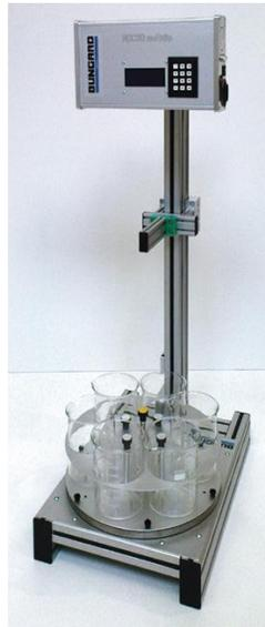
**Figura 12. Dip Coater RDC 30 Multidip, unidad con carrusel multi-solución.**
