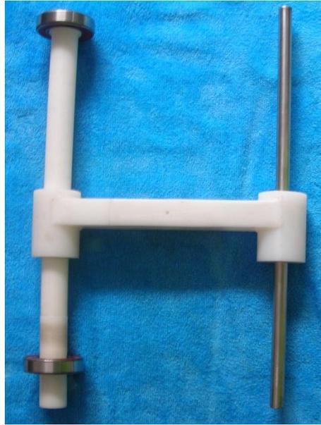
**Figura 32. Mecanismo central fabricado en nylon autolubricado.**
