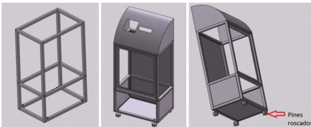
**Figura 29 De izquierda a derecha. Base construida con perfiles estructurales cuadrados Cold Rolled. Base con adición de elementos estructurales fabricados en lámina de acero. Descripción de la ubicación de los pines roscados.**
