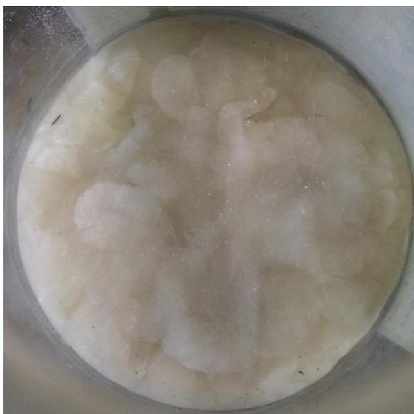
**Figura 10.** Cristales de sulfato de aluminio obtenidos tras evaporar la mayor cantidad de agua restante tras la reacción para la producción del sulfato.
