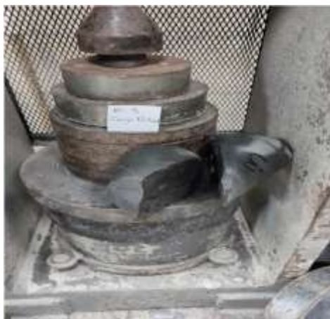
Ilustración 15.2. Ensayo de carga puntual lodolita muestra 3.
