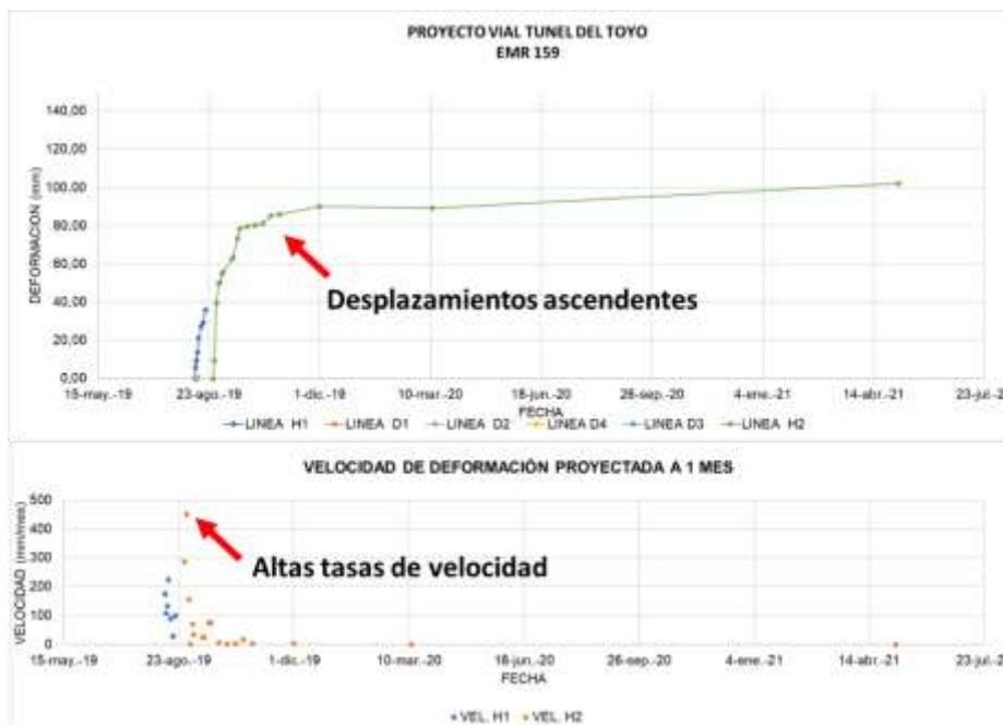
Ilustración 17.5. Estación por convergencias TP 159 PK 36+033,75. Tomado y modificado de: CAM, (2022).
