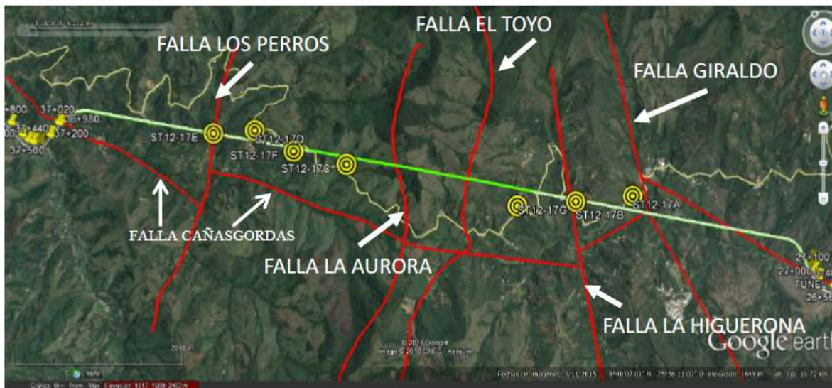
Ilustración 10.10. Fallas principales que inciden en las excavaciones del túnel. Tomado de: Consorcio Antioquia al Mar (2017).
