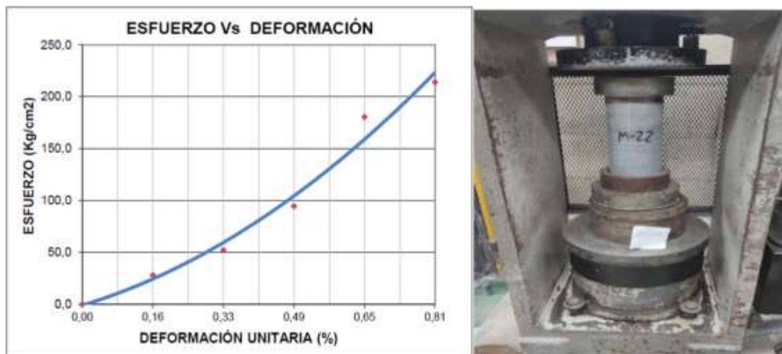
Ilustración 15.1. Ensayo de compresión simple lidita muestra 2.
