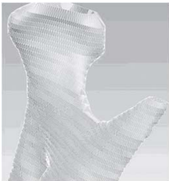
Figura 4. Triangulación Wrap de la nube de puntos
