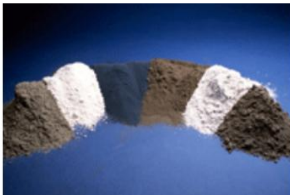
Figura 2.1. Algunas partículas minerales que se adicionan al concreto (Vilanoba, 2009).
