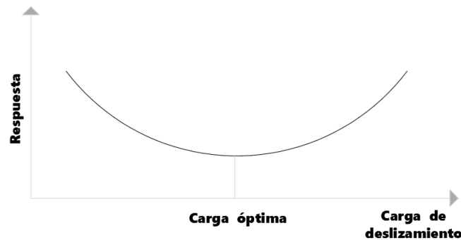
Figura 11. Respuesta vs carga de deslizamiento – Fuente: Elaboración propia
