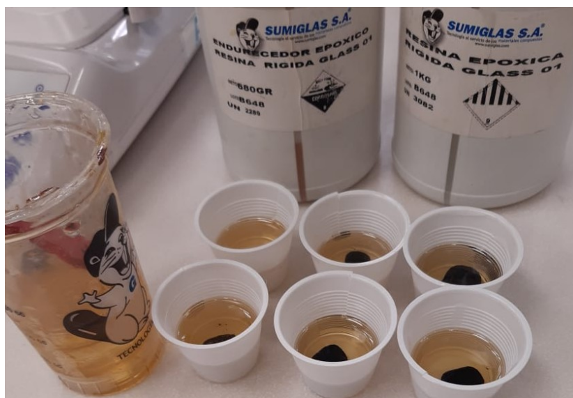
Figura 7 - Preparación de la muestra en resina epóxica rígida
