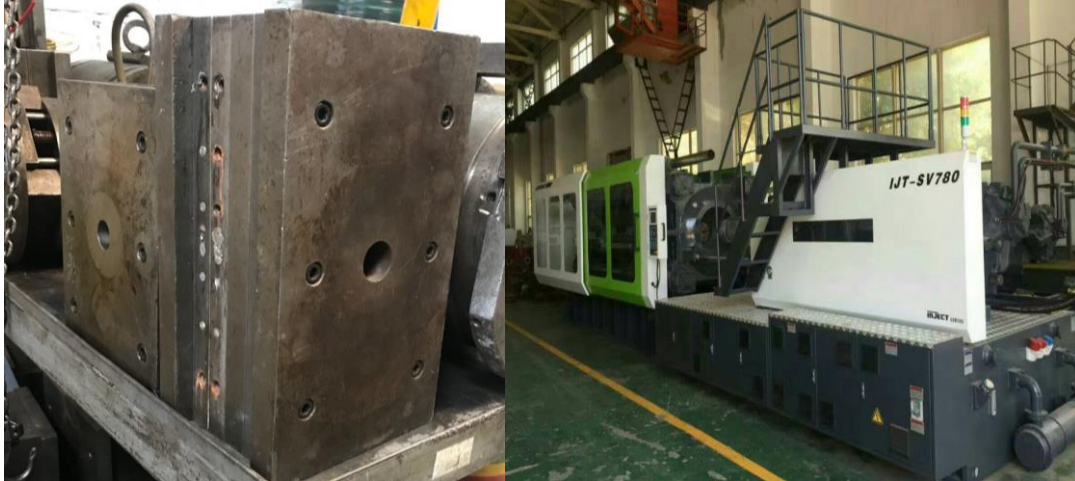
Figura 4. Molde y equipo empleado para la fabricación de las cajas para alojar medidores de energía eléctrica.
