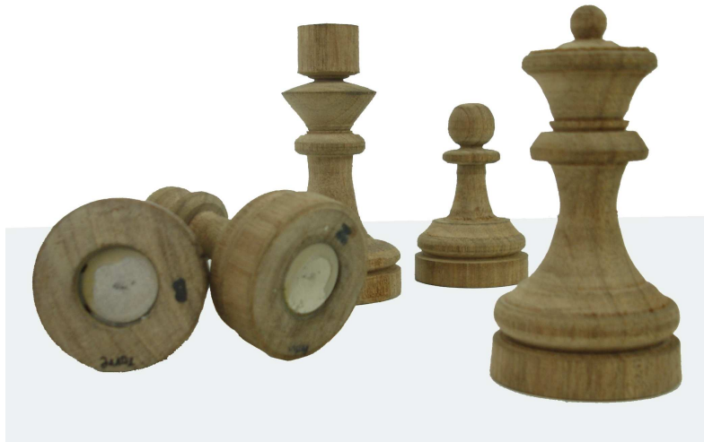
Figura 19. Ubicación de los imanes al interior de las piezas fabricadas. Se construyeron en madera (abarco) debido a los requerimientos de apariencia de la FIDE.
