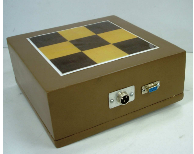
(b) Foto del tablero. Al interior se encuentran los circuitos del microcontrolador, de sensado y de comunicación serial.
