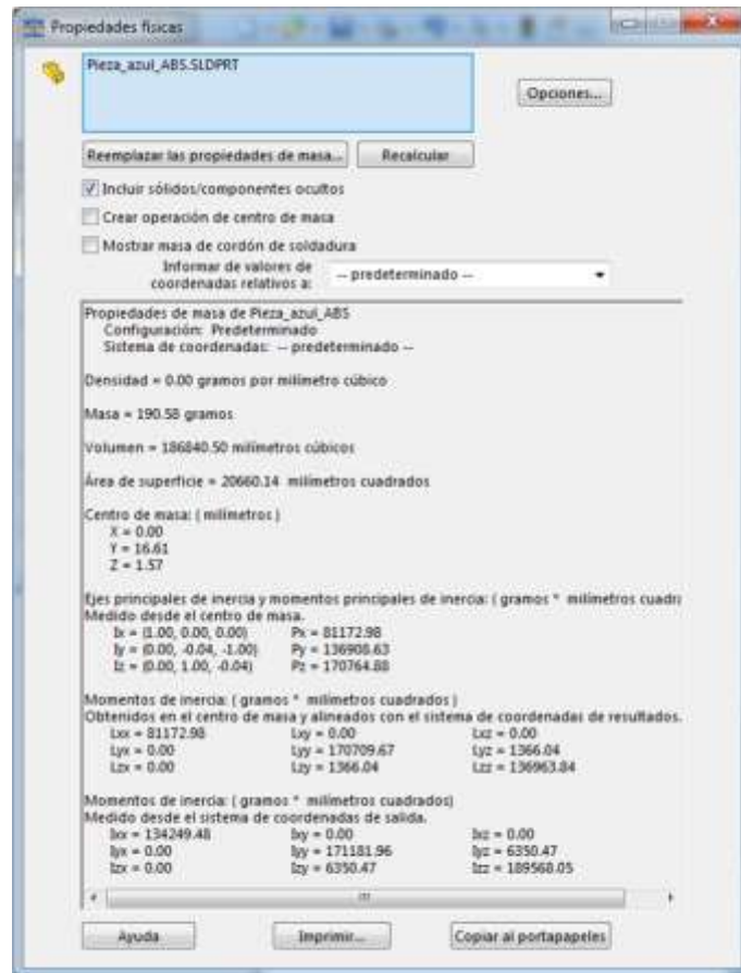
FIGURE 93 EXEMPLE DE PROPRIÉTÉS PHYSIQUES - SOLIDWORKS®
