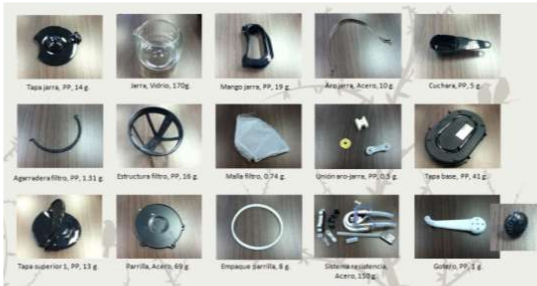
FIGURE 174 COMPOSANTS DE LA MACHINE À CAFÉ
