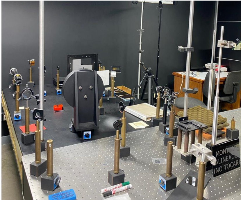
Imagen 3. Montaje de transmisión el cual presentó diferencia en la altura de las componentes e introdujo vibraciones. No exitoso.
