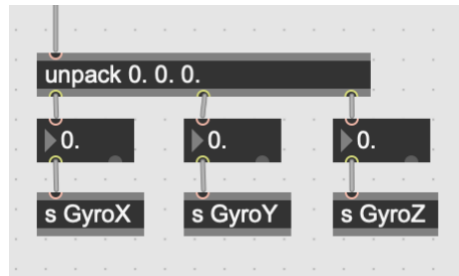
Figura 11. "Patch maestro" MAX: giroscopio
