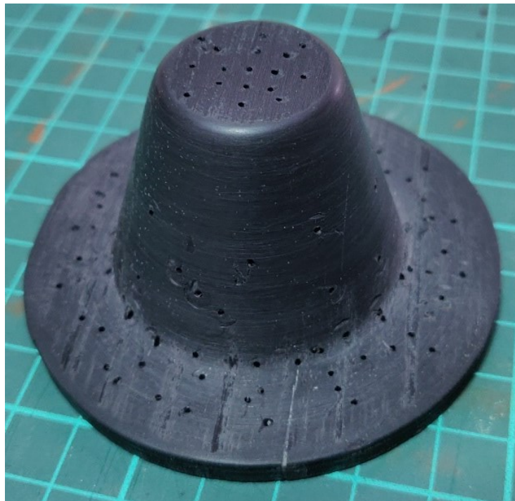
Figura 24 Molde escalado - detalle vacíos
