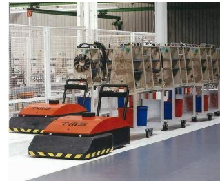
Fig.6 AGV guiado por línea
