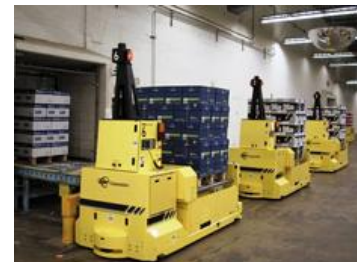
Fig.7 AGV Capacidad en carga 900kg.
