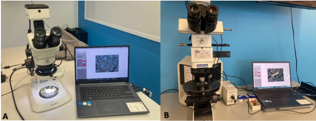
Anexo 5. A- Análisis mediante microscópio estereográfico y B- Análisis de secciones delgadas pulidas mediante microscópio petrográfico.
