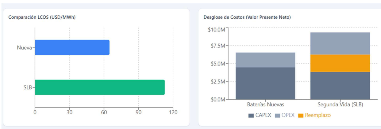
Ilustración 5. Simulación LCOS vs LCOS-SLB Fuente: Propia
