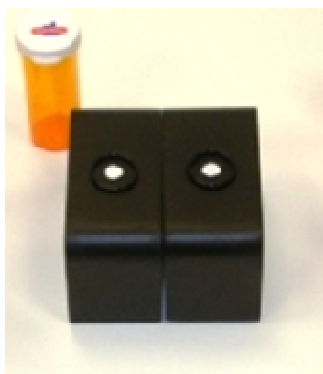
Imagen .. Detectores CALReady UV-Visible Fuente: (35)
