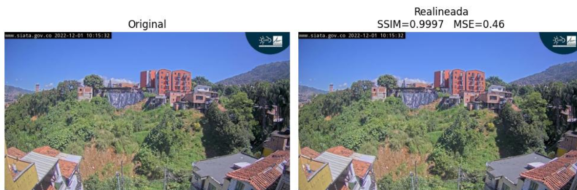
Figura 7. Ejemplo de una imagen original y su versión realineada mediante ORB + RANSAC
