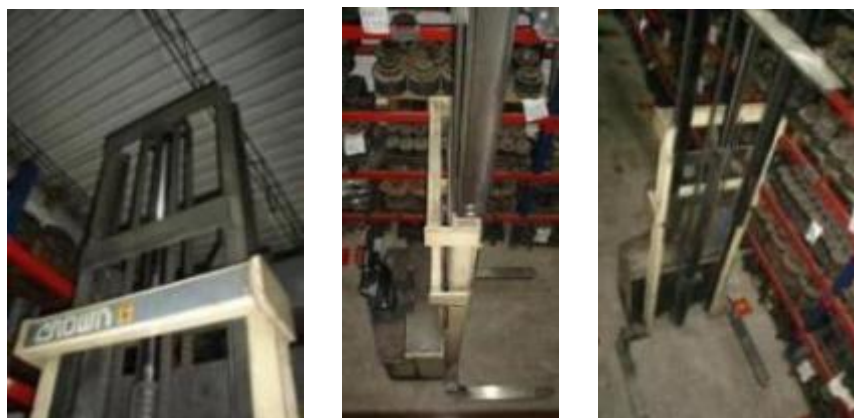
Ilustración 22. Mástil principal y mástil telescópico.
