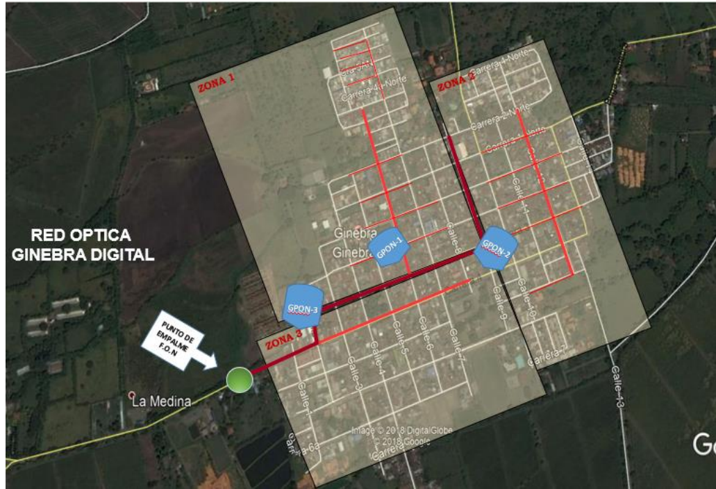
Figura 12. Ubicación GPON y antenas
