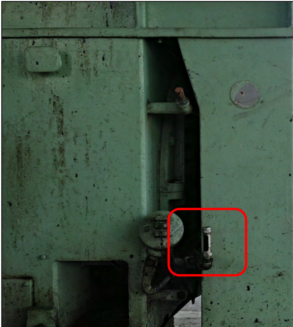
Ilustración 38 - Lubricación de las Chumaceras
