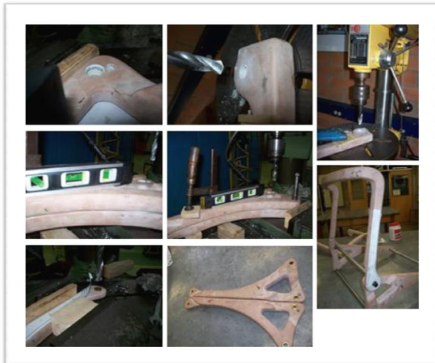
Para unir las piezas metálicas a las piezas de fibra, estas se envuelven en fibra y son sostendias con hilo. Con una fresa y un motor tool se realizan unas cunas en las paredes de los agujeros de las piezas del chasis para remover la espuma y rellenar los agujeros con fibra + resina y se rectifican los agujeros. Como elemento de unión entre piezas se utiliza resina en ambas piezas y se incrusta la
