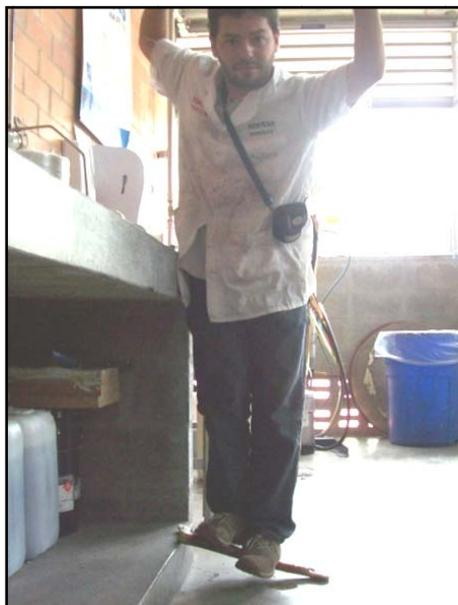
Los resultados fueron muy buenos, pues la pieza resistió el peso de una persona de 65 Kg, a pesar de que la pieza no está bien conformada y está muy expuesta a sufrir desgarros debido a esta clase de esfuerzos.
