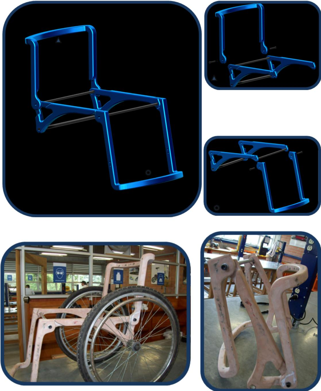
La figura anterior es el resultado de rediseñar la arquitectura de forma del concepto inicial de la silla Vone, se puede observar un diseño de estructura más sólida pensada para brindar una mejor circulación de esfuerzos sobre todo el producto.
