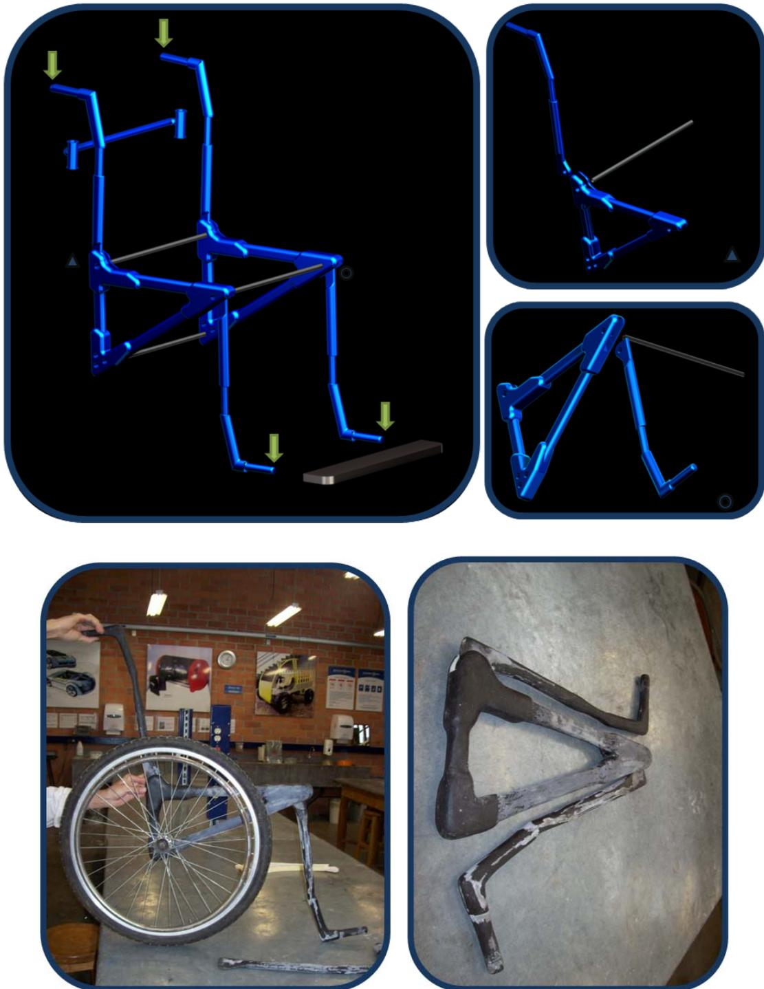
En la figura anterior se puede observar como las flechas están indicando que la estructura de la silla se encuentra discontinua en esos puntos y por lo tanto no evidencia una solidez estructural que inspire seguridad en el diseño, además se ha de necesitar 2 elementos adicionales (plataforma del reposa pies/soporte espaldar)
