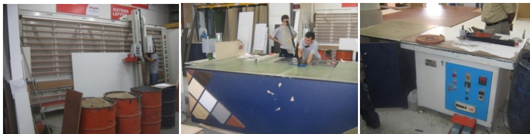
Figura 86. Corte y canteado de lámina.
