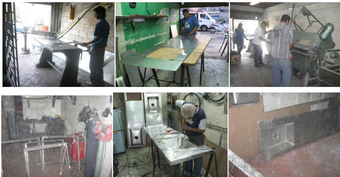
Figura 89. Corte, doblado, soldadura y pulido de lámina de acero inoxidable.
