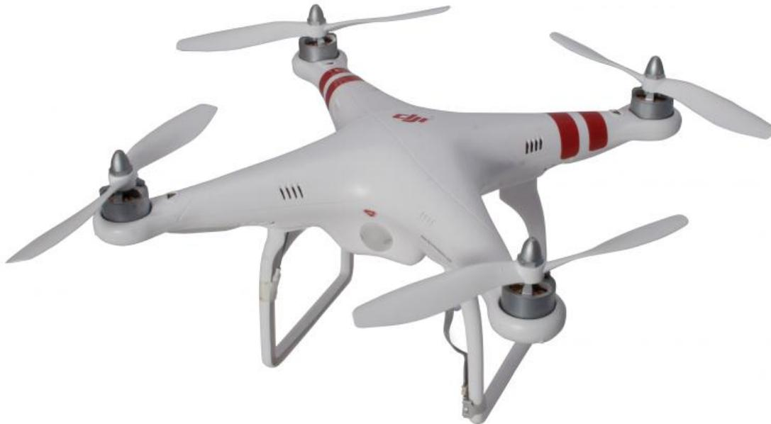
**Figura 4. Cuadricóptero DJI Phantom 1 (DJI, 2015).**
