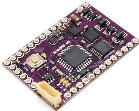
**Figura 37. Unidad de medición inercial ArduIMU V3.**
