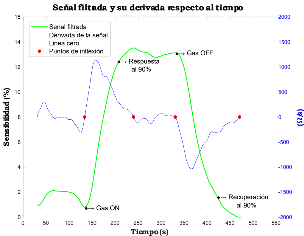
Figura 41. Resultado final del procesamiento de la señal utilizando la derivada para encontrar los puntos de inflexión.
