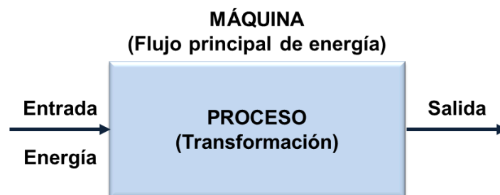
Figura 53. La máquina como sistema de transformación de energía
