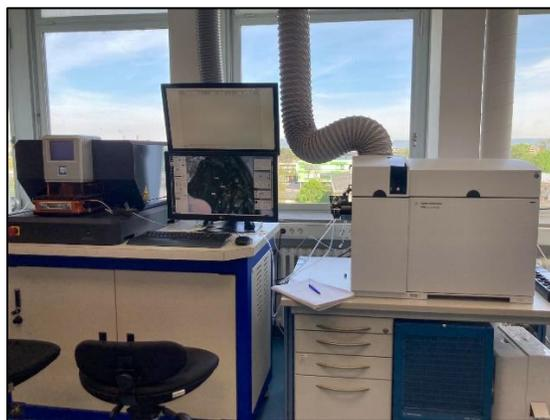
**Figura 18.** Equipo LA-ICP-MS
