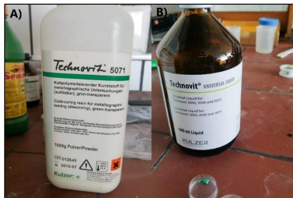
**Figura 14.** Componentes de la resina. A) Polvo Technovit 5071. B) Technovit Líquido Universal.
