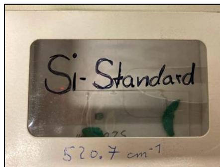
**Figura 6.** Silicio estándar para la calibración Micro-Raman.
