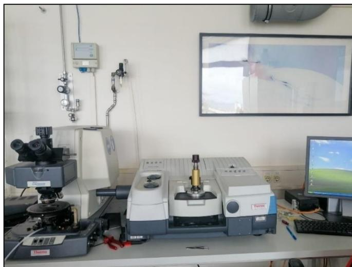
**Figura 11.** Microscopio y espectrógrafo FTIR.
