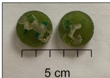
**Figura 17.** Esmeraldas recubiertas con C y pintura de plata líquida.
