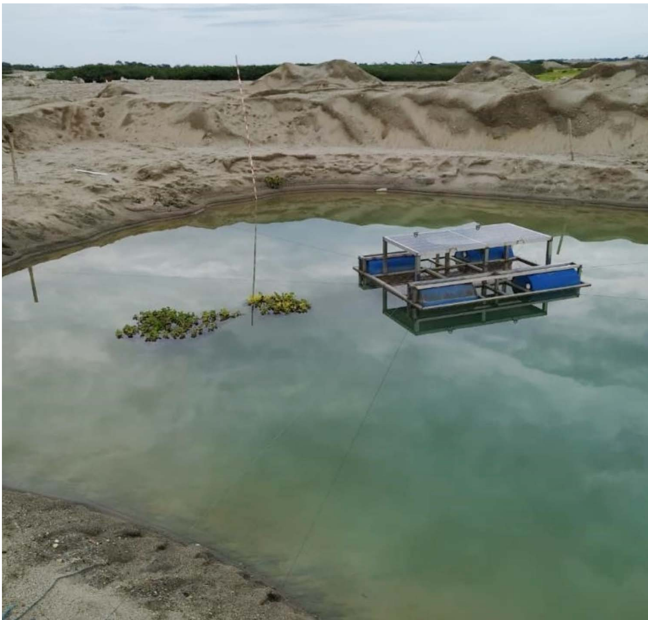
Electro floculador solar. Diseño: De Lápices a Cohetes. Fuente: Esteban González P.
