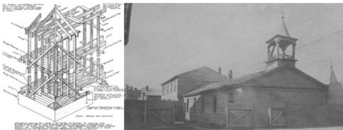
Figura 1 Axonometría constructiva del sistema Balloon Frame (The American Institute of Architects) e Iglesia de Santa María de Chicago (Chicago Historical Society), considerado el primer ejemplo de edificación utilizando la técnica de Balloon Frame.
