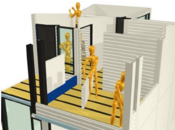
Figura 6 Colocación de paneles divisorios e instalación de puertas y ventanas
