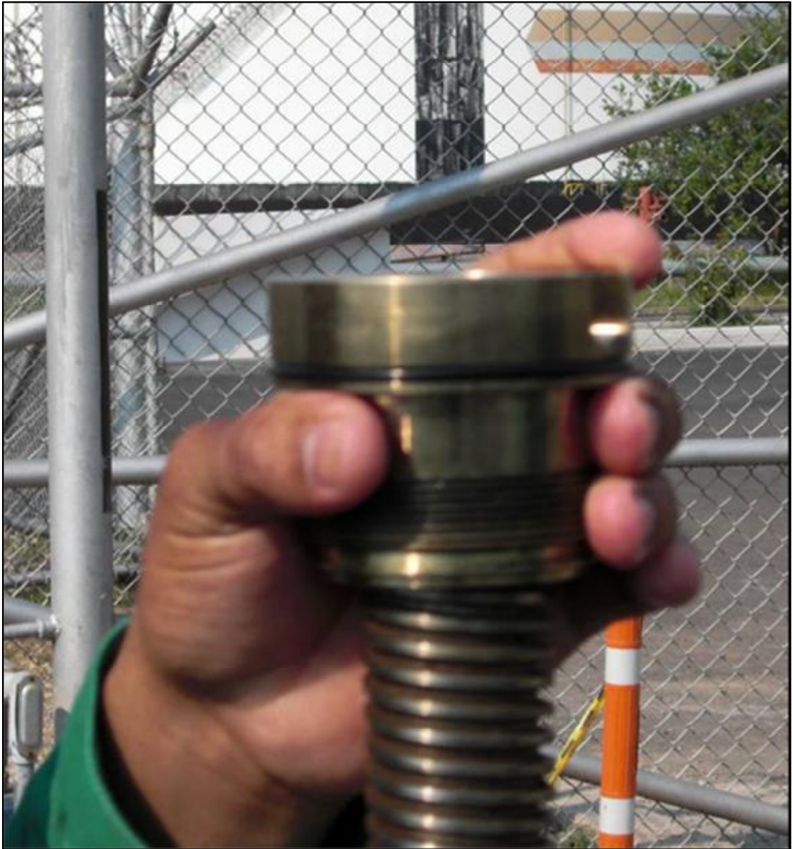
Ilustración 23 - Acople o Drive Bushing como va en el vástago de la válvula.
