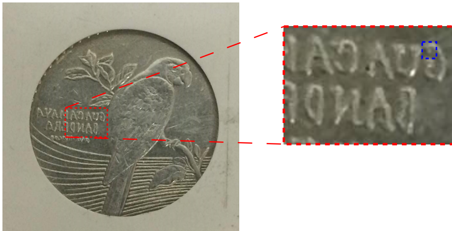
Figura 5-3: Moneda de 200$ observada mediante el microscopio. El zona en el marco rojo fue observada con un sistema de formación de imagen convencional y la azul mediante el sistema de microscopía desarrollado.
