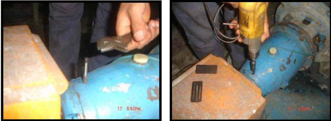
Figura 63. VIBCODE bomba de pulpa
