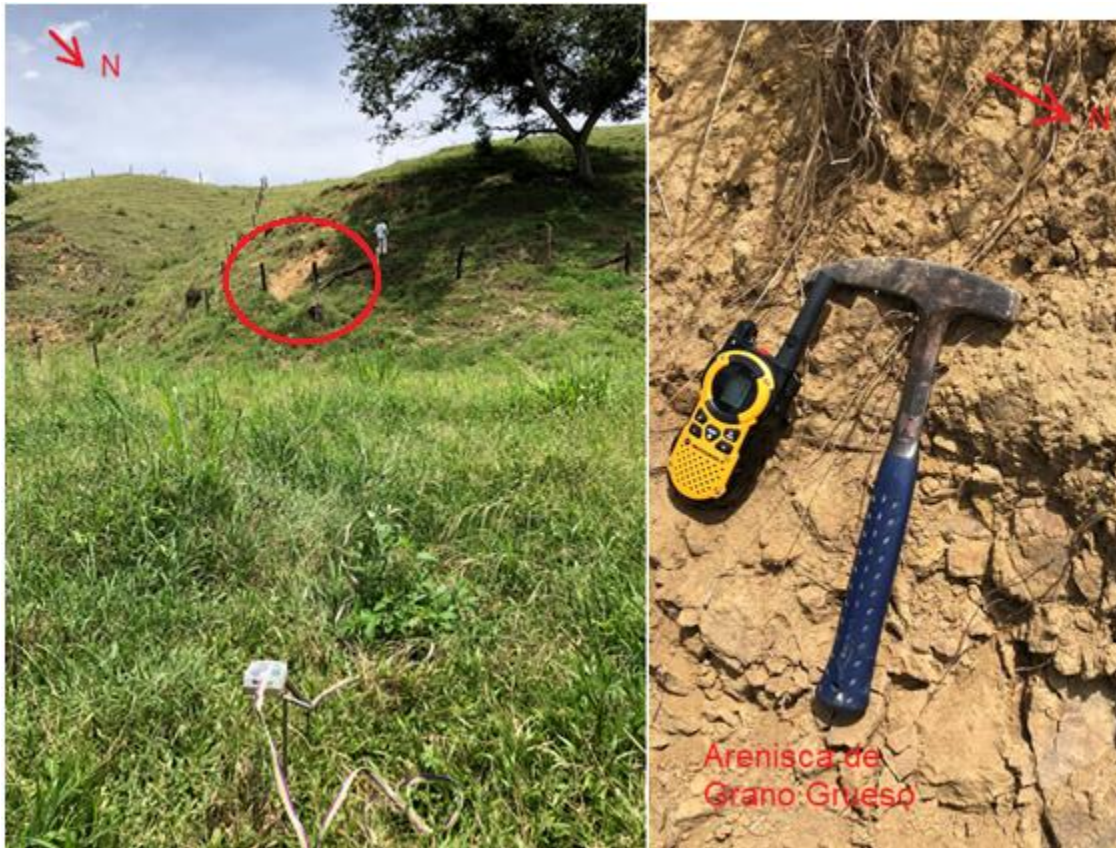
Figura 8. Suelo compuesto por arenas gruesas de cuarzo y líticas.
