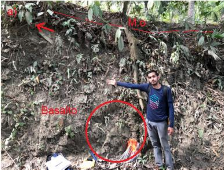
Figura 30. Afloramiento de basalto con meteorización y fracturamiento severa. Capa de materia orgánica (M.o).
