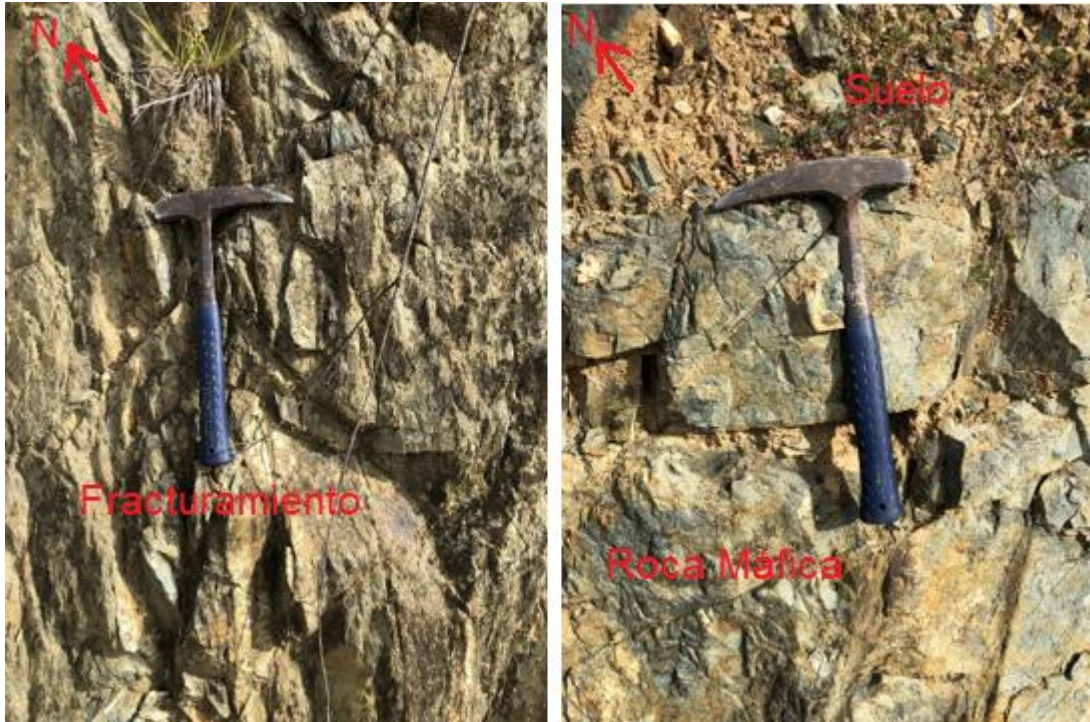
Figura 12. Roca de composición máfica altamente fracturada.
