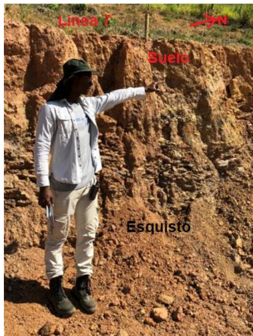
Figura 23. Perfil del suelo grado 3 en esquistos grafitosos- mecáceos.
