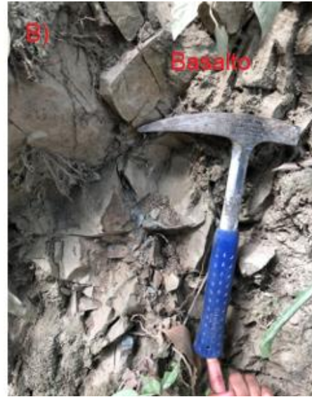
Figura 30. Afloramiento de basalto con meteorización y fracturamiento severa. Capa de materia orgánica (M.o).
