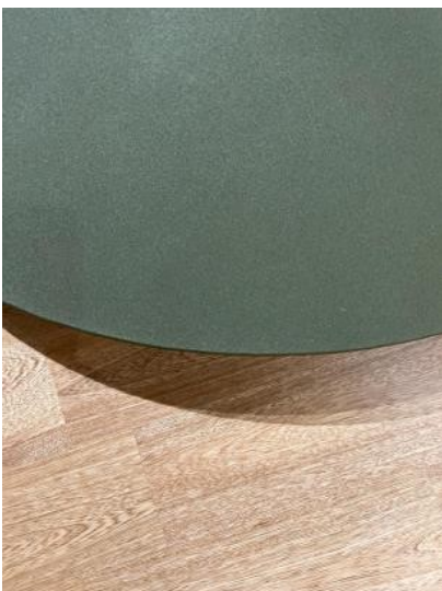
Fig 20. Superficie de roble junto a superficie en acero con pintura electrostática verde acabado lija.
