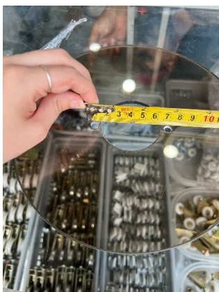
Fig. 79. Pieza en vidrio con perforaciones para tornillos.
