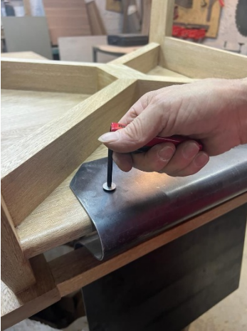
Fig. 93. Estructura inferior y ensamble de lámina metálica
