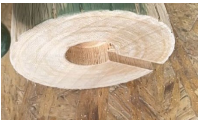
Fig. 77. Ruteado en la parte inferior de la pieza
