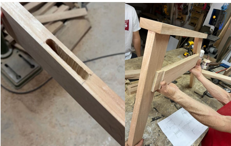
Fig. 89. Proceso de ensamble de patas
