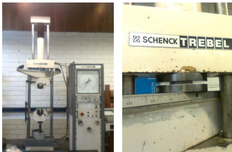
Figura 7: Equipo utilizado y montaje de la prueba de compresión. Fuente: El autor.
