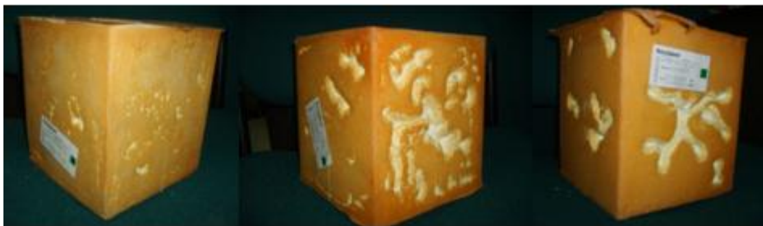
Figura 2: Resultado del primer ciclo de ensayos preliminares de rotomoldeo con Expancel; de izquierda a derecha; PE + 909 DU 80 1,5%, PE + 950 DU 80 1,5%, PE + 093 DU 120 1,5%.
