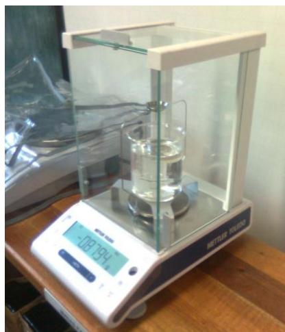
Figura 5: Densímetro METTLER TOLEDO, propiedad del laboratorio de materiales de la universidad EAFIT, utilizado para la medición de densidad de las muestras. Fuente: Los autores.
