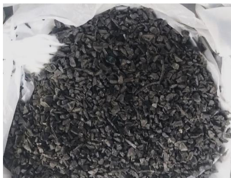
Ilustración 4. Muestra del residuo plástico luego de la molienda en el molino de cuchillas.
