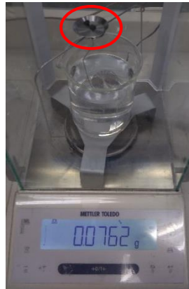
Ilustración 6. Medición del peso en el aire de la muestra polimérica.
