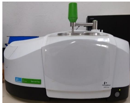
Ilustración 8. Espectrofotómetro FT-IR UATR Two.
