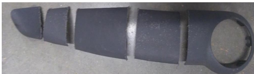
Ilustración 3. Reducción de tamaño inicial de la muestra en la sierra sin fin.
