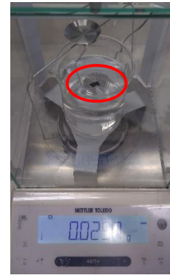
Ilustración 7. Medición del peso sumergido de la muestra polimérica.
