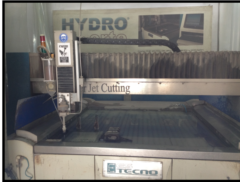
Figura 2 Procedimiento de Corte con agua
