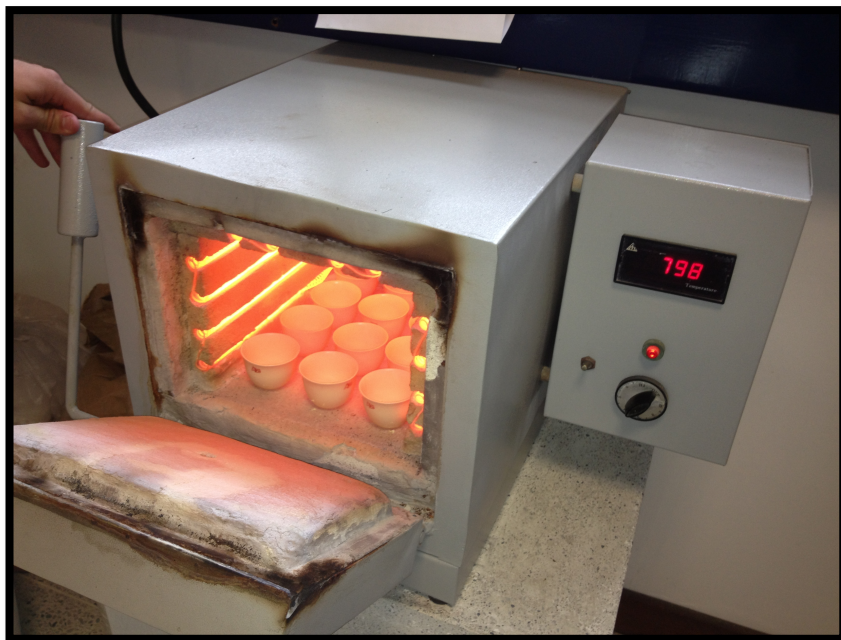
Figura 8 Probetas sometidas a 800°C
