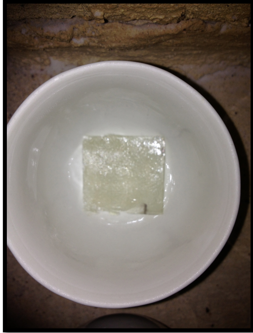
Figura 13 Probeta de incineración
