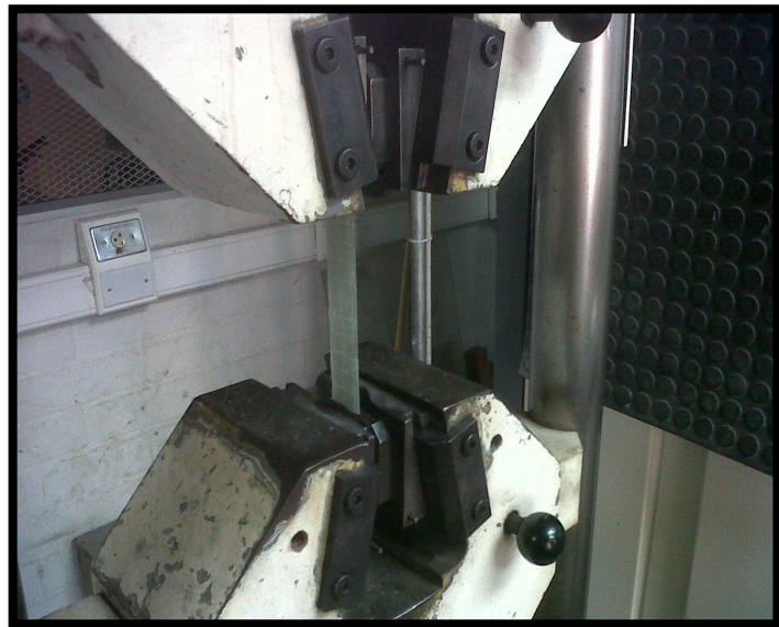
Figura 4 Montaje Schenk Trebel
