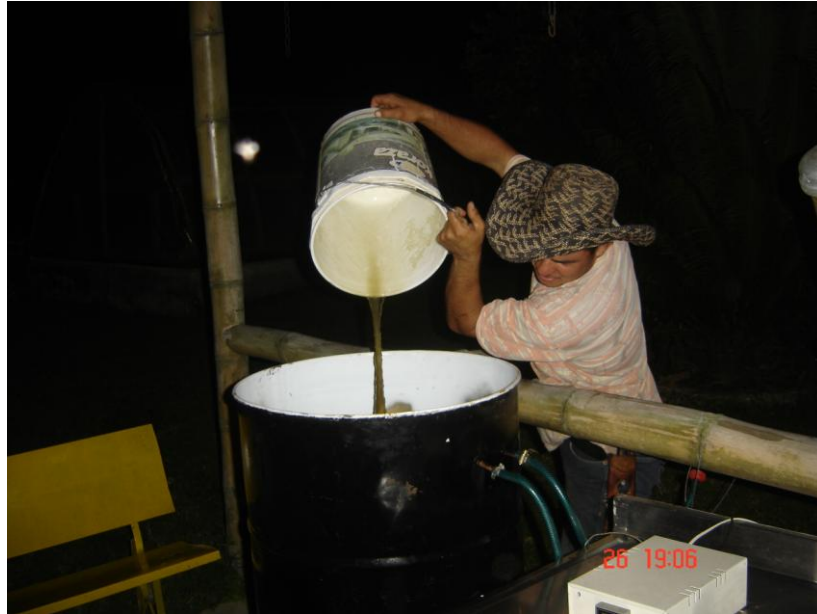
Figura 24. Llenado manual del tanque de fermentación.
