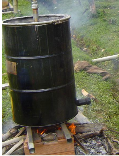
Figura.35. Calentamiento a 34 °C con biomasa.
