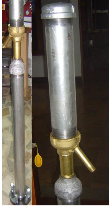
Figura 18. Sección de destilación y condensación parcialmente terminadas
