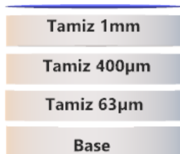
Figura 4. Montaje de tamices para separar los tamaños de granos.
