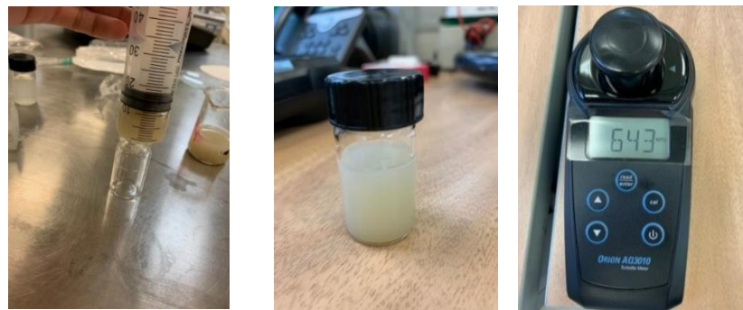
Figura 15 Extracción de muestra y turbidímetro
