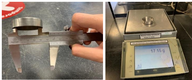
Figura 9 Pie de rey - balanza y peso de cilindro
