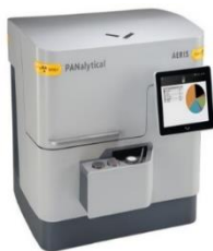
Figura 20 Difractómetro de rayos X – Modelo Aeris. Fuente: Malvern Panalytical
