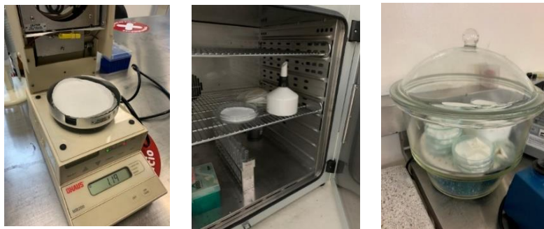
Figura 17 Balanza de humedad con papel filtro, embudo en horno y desecador
