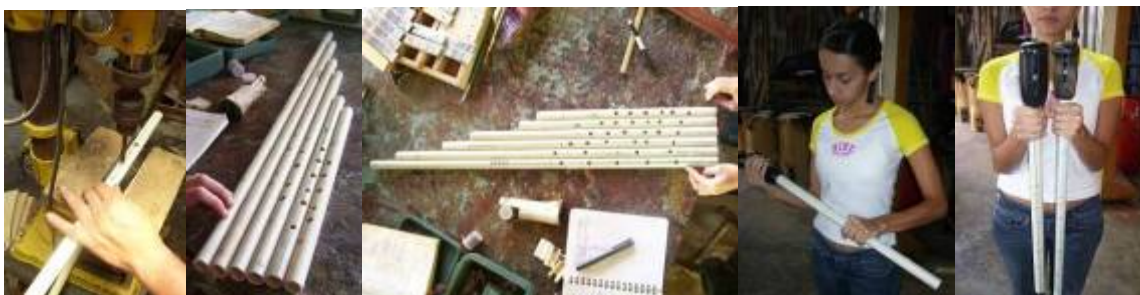
Figura 15. Fabricación de tubos sonoros en diferentes afinaciones
