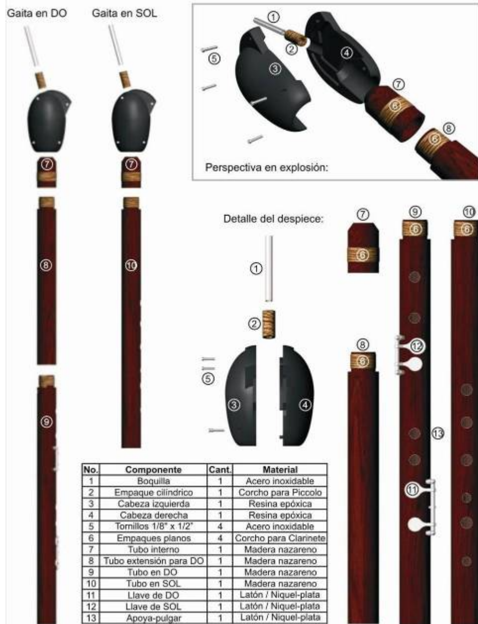
Figura 38. Vistas en explosión y lista de partes de las gaitas en SOL y DO.
