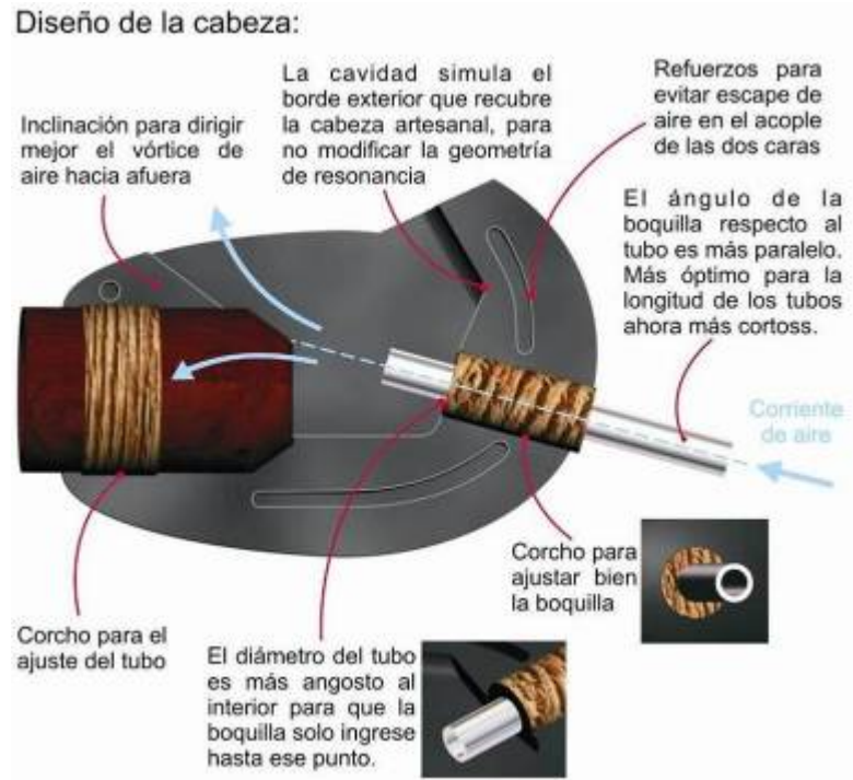
Figura 39. Detalles de la cabeza y el mecanismo de llaves.
