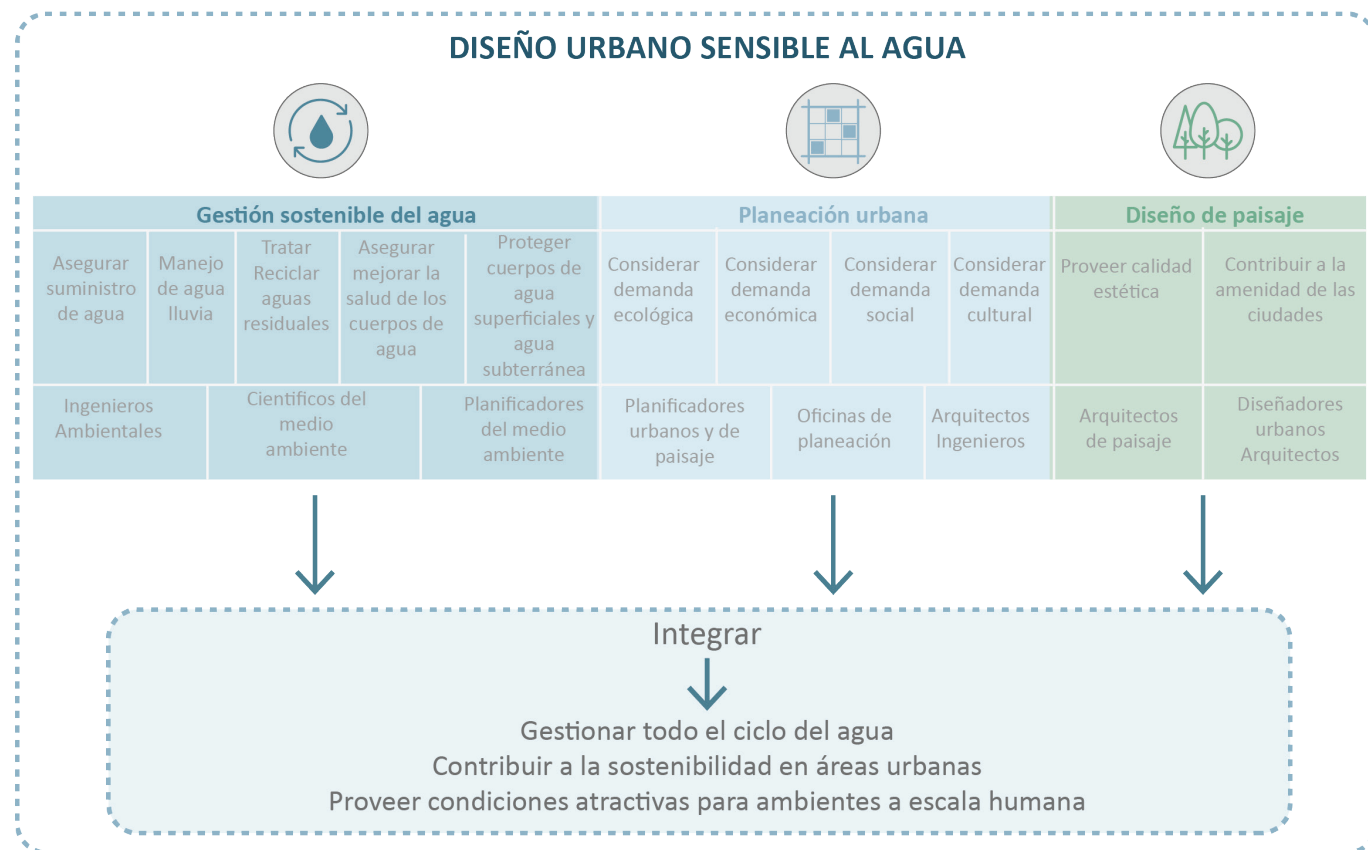
» Figura 24. Componentes del diseño urbano sensible al agua. Fuente: Elaboración propia basado en Hoyer, et al (2011)
